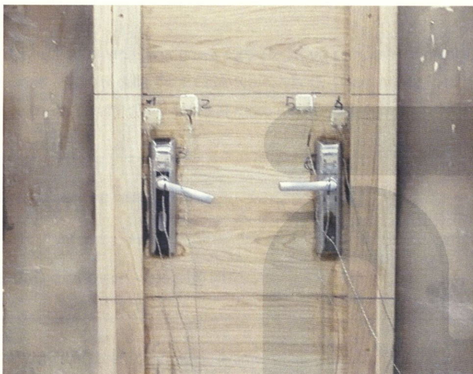
Foto 3: Lato non esposto al fuoco dopo la prova
