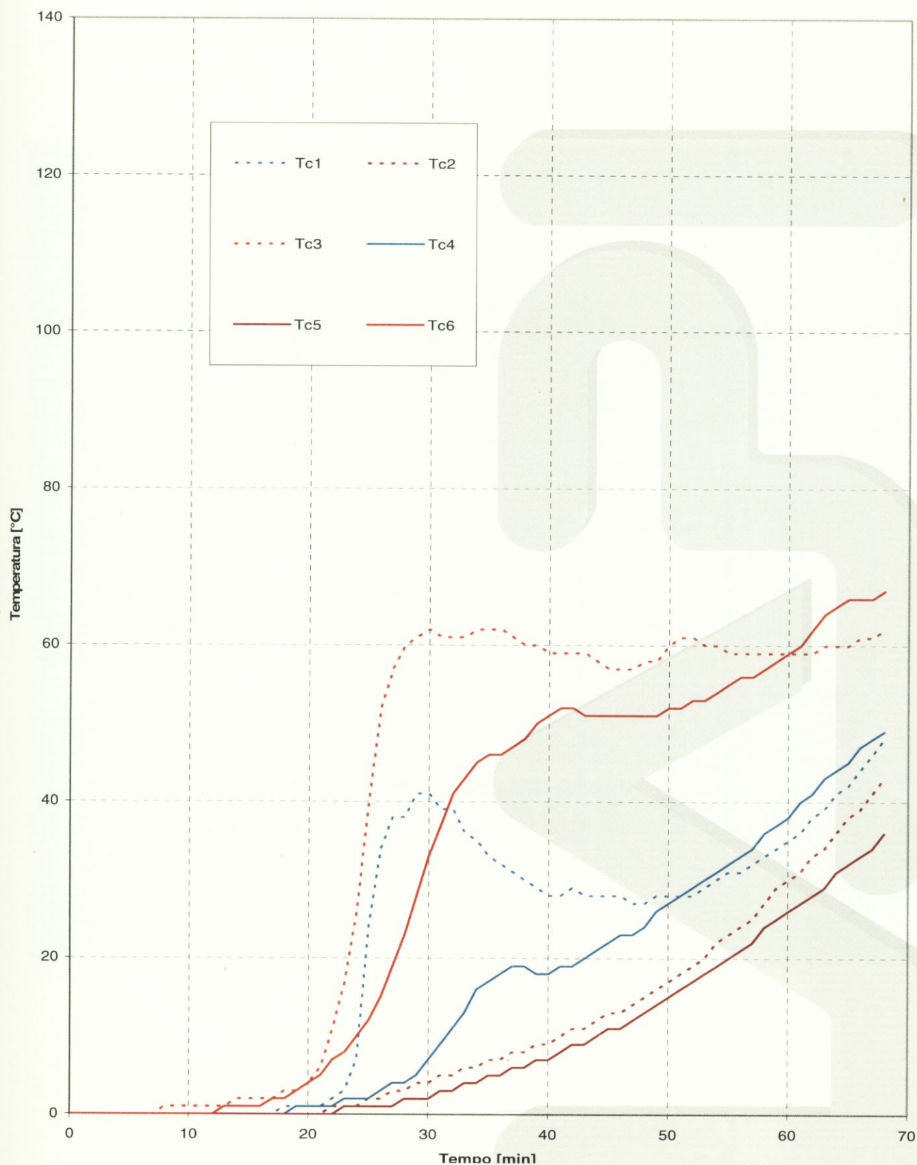
Grafico 3: Incremento della temperatura sul lato non esposto al fuoco
